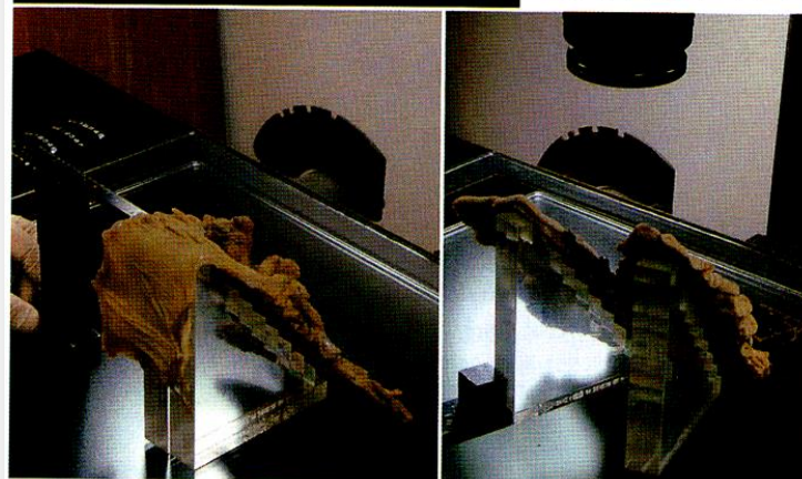
Fig. 10 측면상의 macro사진촬영수기. 삼각을 사용하여 피사체의 옆에서부터 잡는 방법(a)과 피사체의 배치각도를 바꿔서 잡는 방법(b, c)가 있다. 후자(b, c)에서는 계단상의 특수 아크릴판을 사용하여 피사체의 배치 각도를 바꾸고 있다(新潟大學 醫學部分・診断病理學分野 味岡洋一 先生과 山口尚之先生的 후의에 의한)
